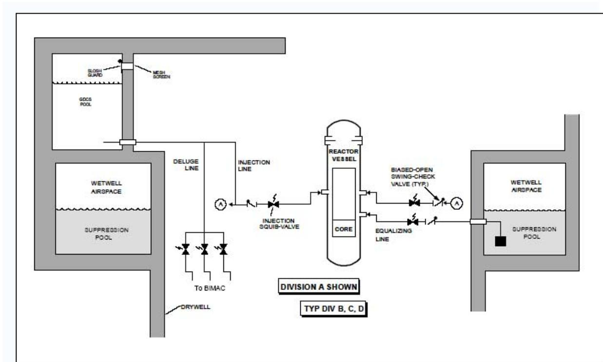
**Figure 23. Gravity-Driven Cooling System**
